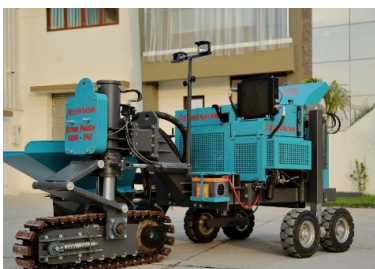
Kerb paver machine (01 Nos)
